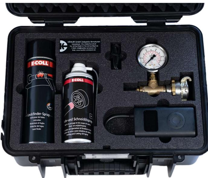
Eine Luftüberdruckprüfung ist mit 0,2 bis 0,5 bar nach dem Sichtverfahren mit einer Prüfzeit von mindestens 1 Minute durchzuführen. Die Prüfung ist im Anbohrprotokoll zu dokumentieren.
